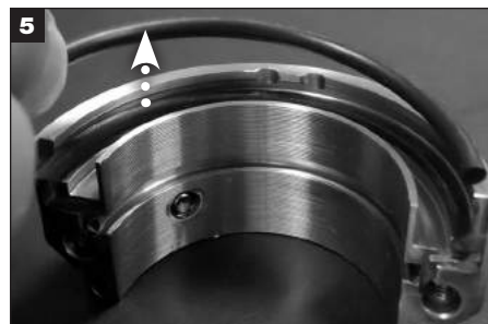
Verwijder de gebruikte O-ringhelften van het roterende dichtingsvlak.
