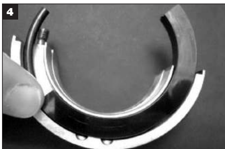
Verwijder de gebruikte roterende dichtingsvlakhelften door tegen het einde van het vlak te duwen en dit uit de rotatorhouderhelft te schuiven.
