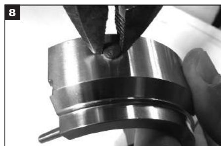
Verwijder de gebruikte centreerknoppen van de buitenkant van de rotatorhouder.
